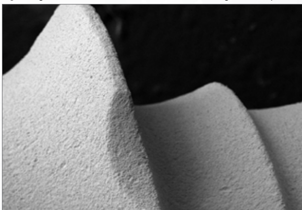
Fig.3 - Topografia Superficiale mediante SEM che evidenziano la superficie pulita senza residui.
